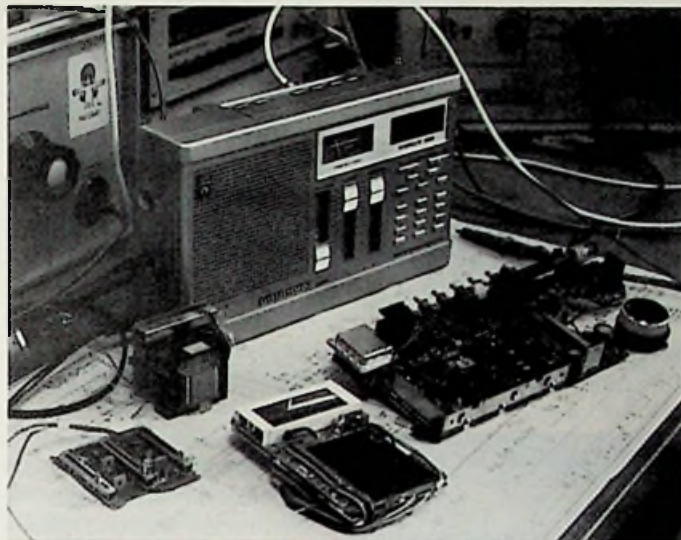
Bild 1: Der Satellit 300 und seine wesentlichen Baugruppen (v. l. n. r.): Lautstärke-/Klangebinsteller, Netzteil, Eingabetastatur mit Uhren-/Frequenz-Display und Mikrocomputer, Empfangs- und Verstärker-teil sowie der „Handabstimmknopf“ (Inkrementengeber) (Grundig-Pressfoto)
